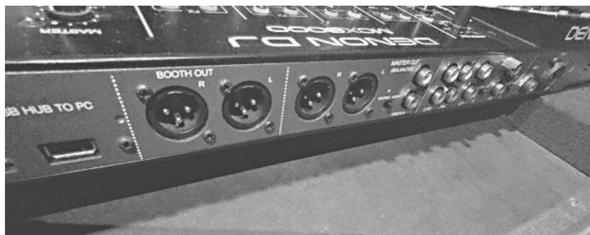
Снимка 4. Балансиращи и небалансиращи изходи на диджей контролер Denon MCX8000
