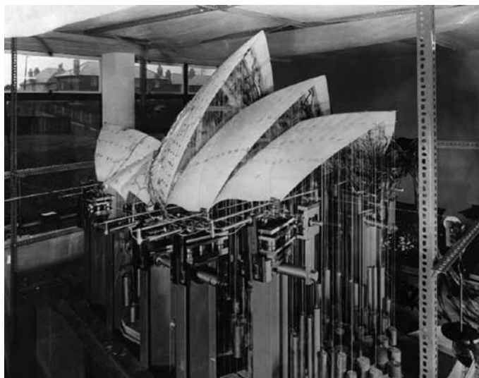
Ил.3. Модел на покрива на операта в Сидни, подложен на изпитване за разпределение на напрежението в университета в Саутхемптън, [фотография, 1960 г.] © Henk Snoek / Courtesy Arup.
