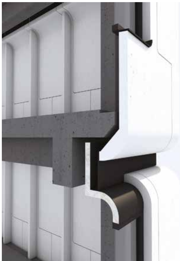
Ил. 10. Детайл-разрез от фасадата, BIM модел, Т. Харалампиева
