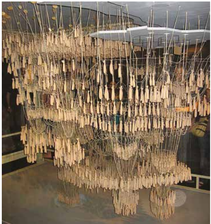
Ил. 3. Макет на обърнатите усилия на А. Гауди за Колонията Гюел
