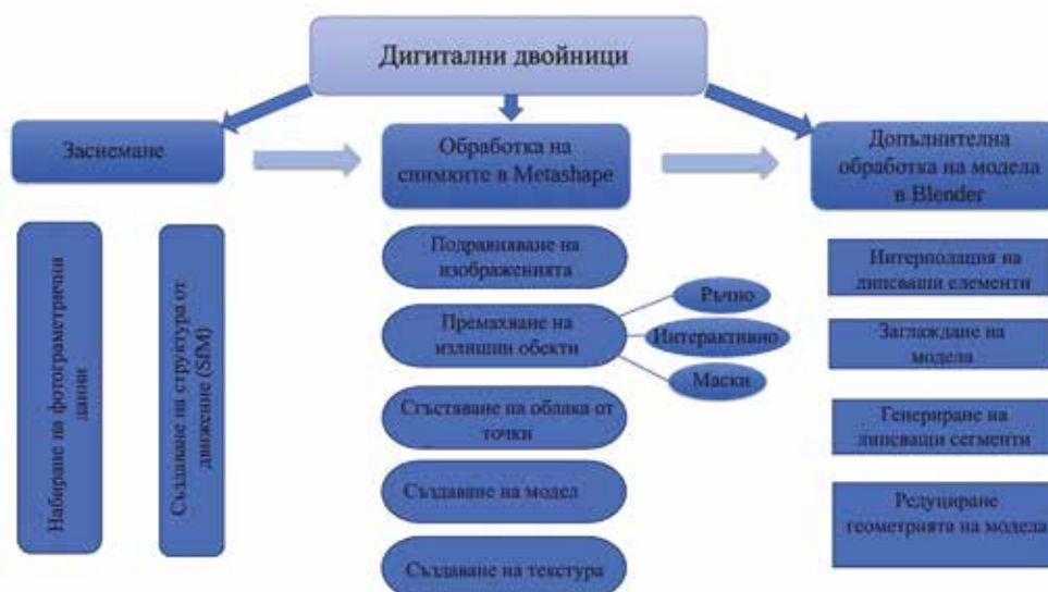
Ил. 6. Създаване на дигитални двойници – технологична схема. © Д. Филипов, С. Кацарска-Филипова
