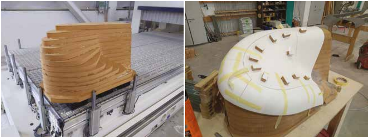
Ил. 8. Производство на калъпи; Soliform (2023)
