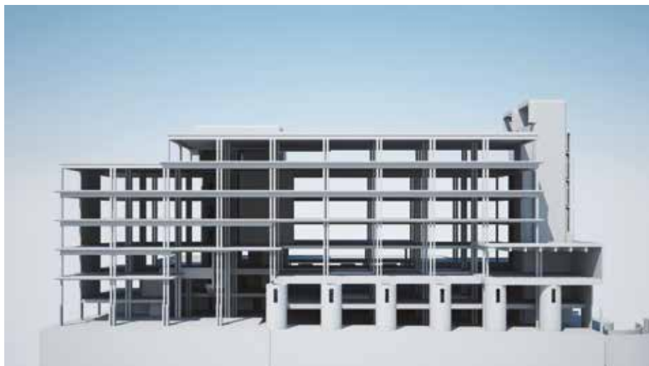
Ил. 5. Носещата конструкция, визуализация Т. Харалампиева
